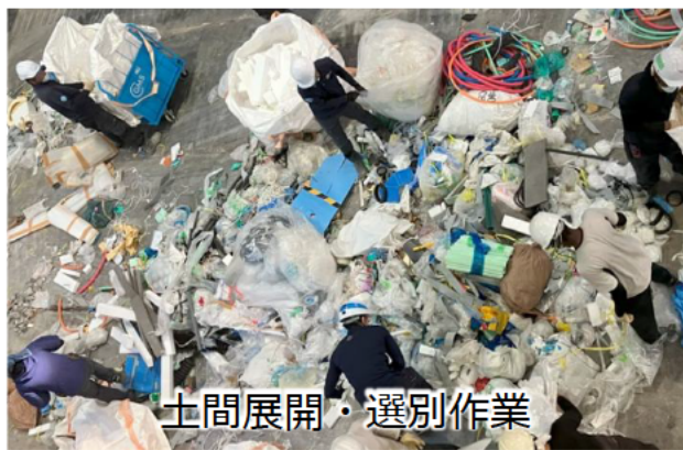
写真6 土間選別の作業状況
